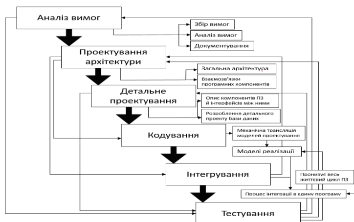
Рис. 1. Схемна модель процесу модульного програмування
