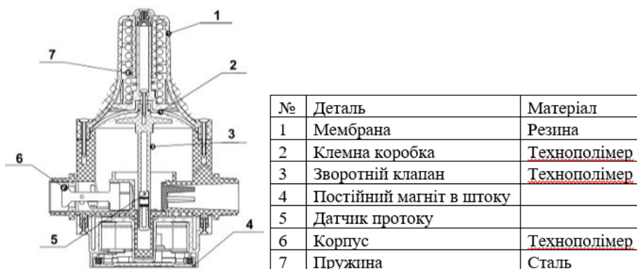
Рис.3. Структурна схема реле тиску Katran
