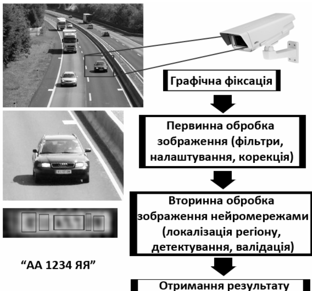
Рис. 1. Структура системи розпізнавання та ідентифікації ТЗ
